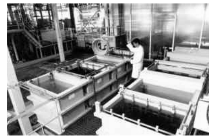
Traitement chimique en bain – Source : DEC SA
