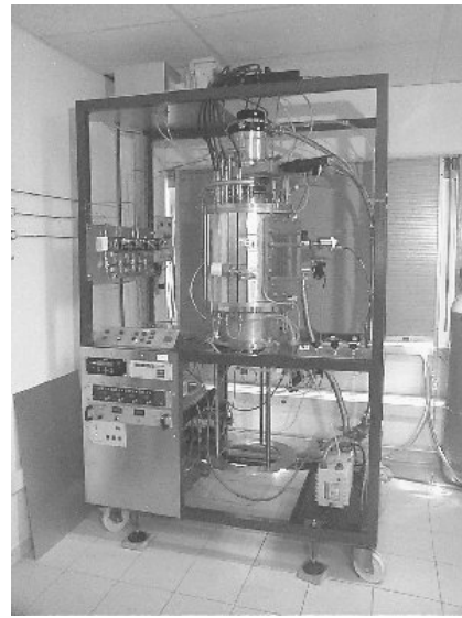
Équipement pour traitement par plasma froid Source : Biophy
