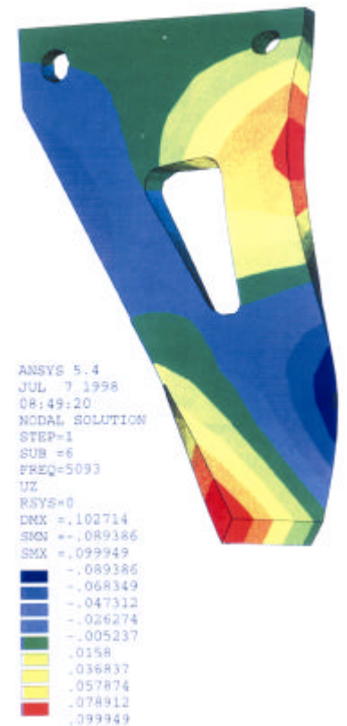
Figure 1 : déformation d'une équerre soumise à des vibrations
