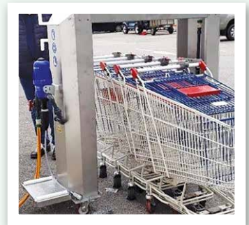
Machine de désinfection des chariots des grandes surfaces conçue par JC3D.
